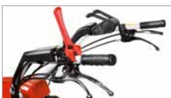
Los frenos independientes y la rotación de la columna del manillar facilitan las maniobras en los terrenos más difíciles.
