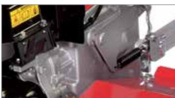
Transmisión directa de engranajes en el cigüeñal, muy resistente al esfuerzo.
