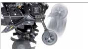
Rueda frontal para transportar la máquina. Se levanta fácilmente, sin herramientas, para facilitar la labor en la tierra.
